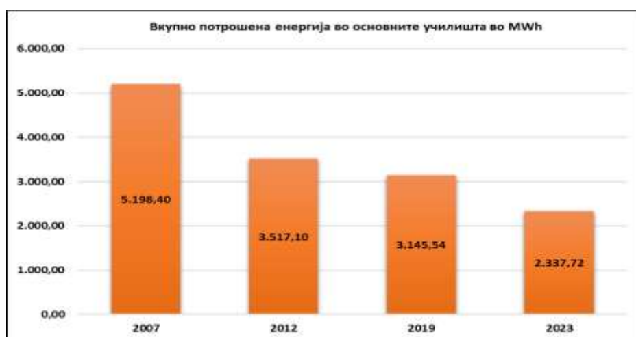
Графикон 10. Графички приказ на разлика во потрошувачката на енергија пред и по имплементирањето на мерките за енергетска ефикасност во основните училишта
