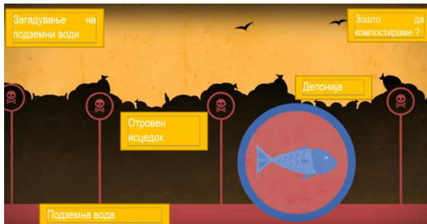
Слика 10 Депонискиот исцедок ја загадува подземната вода
