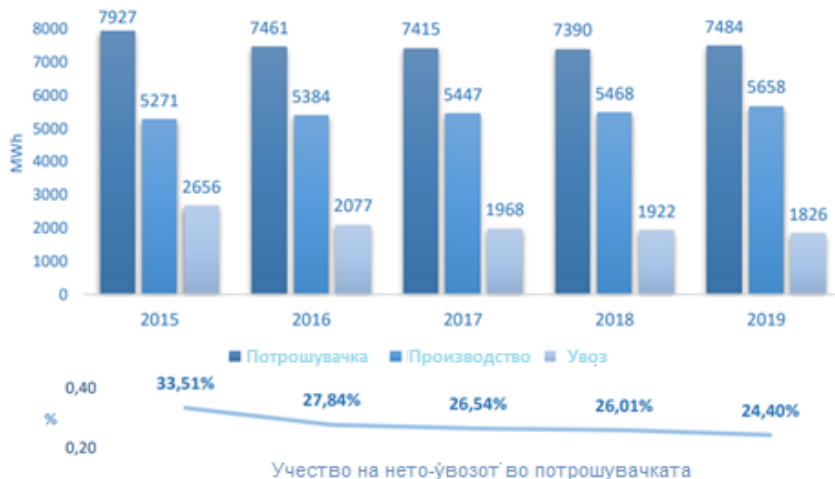
Слика 3 - Потрошувачка, производство, нето-увоз на електрична енергија и учество на нето-увозот во потрошувачката на електрична енергија во периодот од 2015 до 2019 година (изразено во MWh и %)
